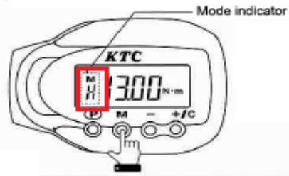
a. กดปุ่ม (+/C) หรือ (-) เพื่อตั้งค่า Torque ที่ต้องการ เมื่อได้ค่าที่ต้องการแล้วให้กดปุ่ม M ค้างไว้เพื่อบันทึก
